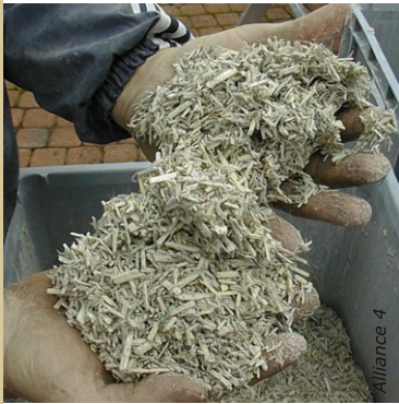
Le chanvre stabilisé est un isolant haute densité, à déverser en vrac et à tasser.
