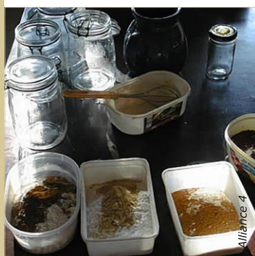
Recherche de teinte pour la coloration d'un badigeon. Il est possible de mélanger plusieurs pigments entre eux.
