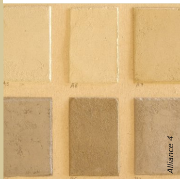
En plus des pigments, les sables utilisés dans la préparation des enduits influencent aussi la teinte. Ici ce sont les poudres de marbre noir et vertes qui teintent les enduits de finition.
