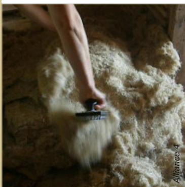
La taloche à pointes sert à carder la filasse pour l'aérer par un mouvement de grattage rapide et souple.
