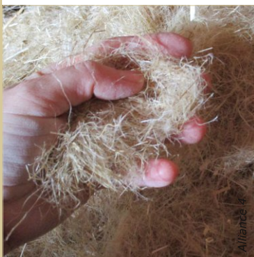
La filasse de chanvre courte, une fois décompactée à l'aide d'une taloche à pointes, s'utilise comme isolant en vrac.
