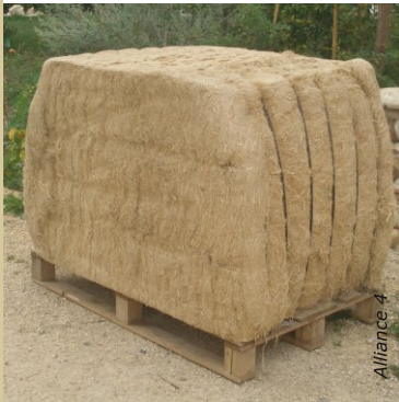
La filasse de chanvre se présente sous forme de balle comprimée et cerclée, de 285 kg environ.
