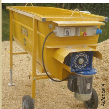
Le malaxeur à axe horizontal permet un brassage rapide et homogène du béton de chanvre. Vous en trouvez en location chez Alliance 4.
