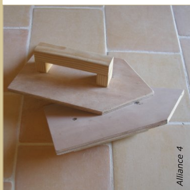
La taloche à tasser est nécessaire à la mise en place par tassage du béton de chanvre.
