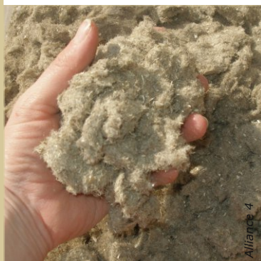
La ouate de chanvre est de la fibre en très fines particules.
